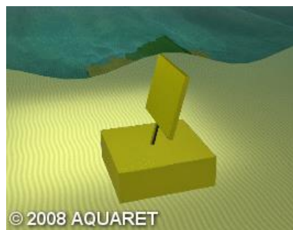
圖 4 波浪擺盪衝擊式示意圖
